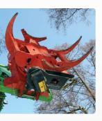
Mit diesem Fällkran der neuesten Generation steht der Nürnberger Baumpflege GmbH ein vergleichsweise leichtes Gerät zur Verfügung. Bodenstrukturen werden mehr geschont als beim Einsatz größerer Maschinen. Der Fällkran ist darum auch in Parks und auf Gehwegen einsetzbar. Der Bodendruck der Agrarbereifung liegt im PKW-Bereich.
